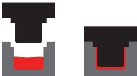
**Das Gießschmieden** ist ein sehr spezielles Gießverfahren. Es basiert auf einer turbulenzarmen Formfüllung. Das geschmolzene Metall wird in eine offene und temperierte Form dosiert und im Anschluss unter sehr hohem Druck geformt.
