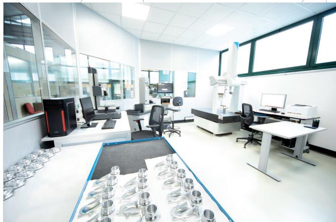
Un ufficio, interamente dedicato al controllo, verifica le quote dimensionali con la possibilità di qualificare al 100% il prodotto e, su richiesta, fornire certificati ISO. Tutto questo, tramite strumenti di precisione: macchine di Proiezione e Controllo dimensionale, Macchina di misura dimensionale CMM, Profilometro e Rugosimetro CNS.
