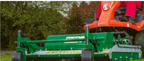
Schwerlasträder mit robusten Innenlagern
