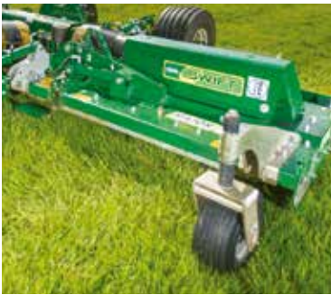
Option für ein Lauftrad pro Flügel, für Rennbahnanwendungen.
