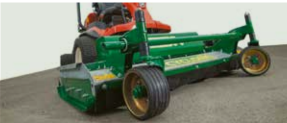
Schnitthöhenverstellung zwischen 10 und 110mm
