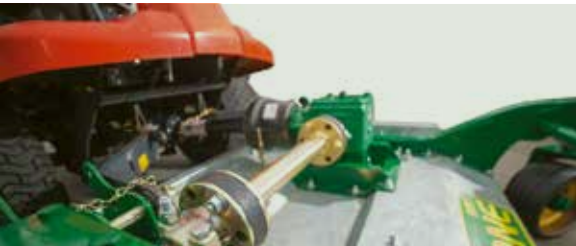
Robuste Bauweise und zahnradgetriebenes Messersystem
