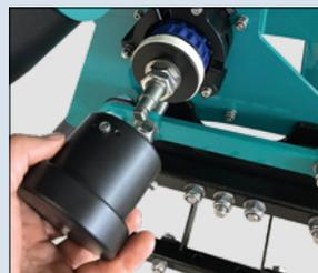
Werkzeuglose Montage und Demontage der Zellenradwelle sowie der Schläuche
