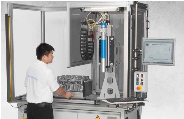
Prüfplatz mit manueller Beladung für Kleinserien-/Prototypenfertigung
