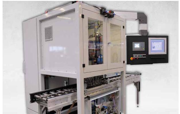
Bandüberbautes System für Reihenmotoren in der Großserienfertigung
