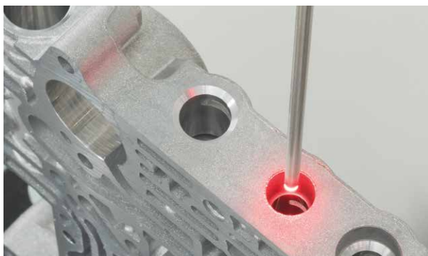
Optische Oberflächeninspektion in Bohrungen (hier: Ventilsteuersplatte)
