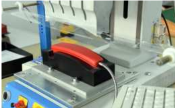
Ultraschallschweißen eines Hörers
