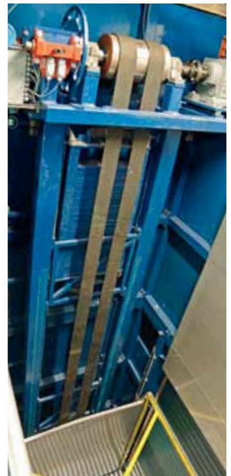
Antriebsstation des Schwerlast-Konsolhebers mit Getriebemotor, Kupplung, Antriebstrommel und Verriegelung
