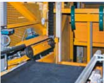
Bei Fördergüter gleicher Abmessungen sind die Fördertische an umlaufenden Gummiblockketten über „Hängestiele“ gelenkig angebracht und werden in Führungsschienen aus Kunststoff über die gesamte Länge parallel geführt. Damit ist ein ruhiger, erschütterungsfreier Lauf garantiert.
