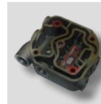
Um für Aluminium gleichmäßige und schmale Entgratkanten productionssicher zu realisieren, wurden spezielle Fräswerkzeuge mit langer Lebensdauer entwickelt, die so konstruiert sind, dass ein Eindringen in das Werkstück begrenzt wird.
