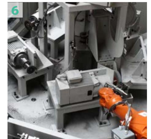
Die Roboterzelle ist für die Rundumbearbeitung von Werkstücken konzipiert.
