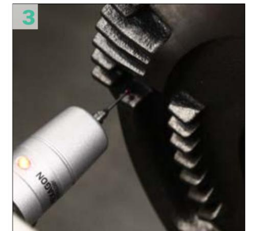
Das auf dem Beladetisch positionierte Werkstück wird vom Roboter gegriffen. Mit Hilfe einer Kamerasensstation und Demo 3D-Messtaster wird das Werkstück ausgerichtet und vermessen.
