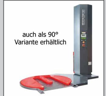
Der Palettenwickler SH-FG 2000 BW ist unser Modell für automatisches Einstretchen von Paletten mit Vorreckanlage. Sie ist besonders für das Einstretchen von leichteren Paletten geeignet. Der Drehteller hat einen Durchmesser von 1500 mm und ist frequenzgesteuert. Durch die Aussparung im Drehteller kann die Maschine einfach durch Flurfördergeräte und Gabelhubwagen bestückt werden.
