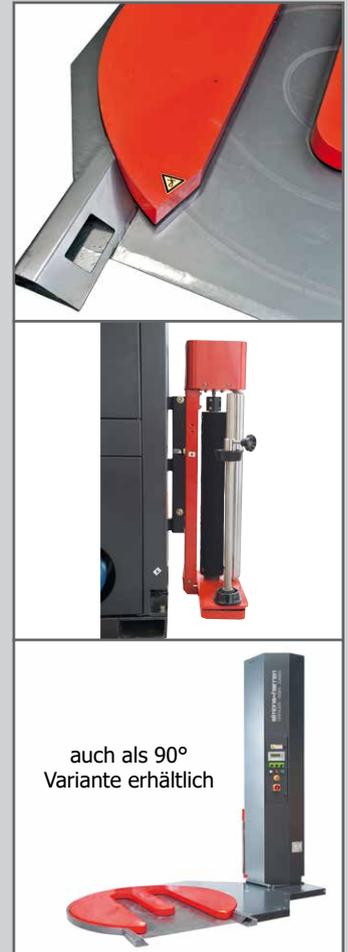
Der Palettenwickler SH-FG 2000 AWE ist unser Modell mit Drehtelleraussparung (M-Teller) zum Einfahren mit Gabelhubwagen ohne Auffahrrampe. Die Maschine verarbeitet ebenso handelsübliche Maschinenstretchfolie. Der Drehteller hat einen Durchmesser von 1500 mm und ist frequenzgesteuert. Der Folienschlitten ist für das automatische Abtasten der Palettenhöhe mit einer Fotozelle ausgerüstet.
