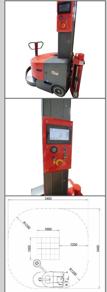
Der Stretchroboter SH-CTP-600 A ist ein unabhängiges Modell für automatisches Einstretchen von Paletten. Die Maschine verarbeitet Standardfolie ohne Vorreckanlage. Der SH-CTP-600 B ist mit einer Vorreckanlage ausgestattet und verarbeitet Powerfolie mit einer Dehnung von 250%. Die Mindestgröße für Paletten beträgt 600 x 600 mm. Der Folienschlitten ist für das automatische Abtasten der Palettenhöhe mit einer Fotozelle ausgerüstet.
