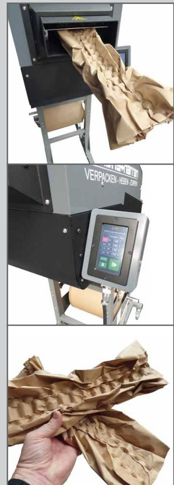
Unsere benutzerfreundliche Papierpolstermaschine SH-PP650 ist die ideale Wahl, um Füll- und Polstermaterial aus Papier einfach herzustellen. Diese Maschine ist mit einer automatischen Schneidvorrichtung ausgestattet, die auf Knopfdruck das gewünschte Füllmaterial für den effektiven Schutz und die Polsterung Ihrer Produkte erzeugt, um sicherzustellen, dass sie optimal vor Stößen geschützt sind.
