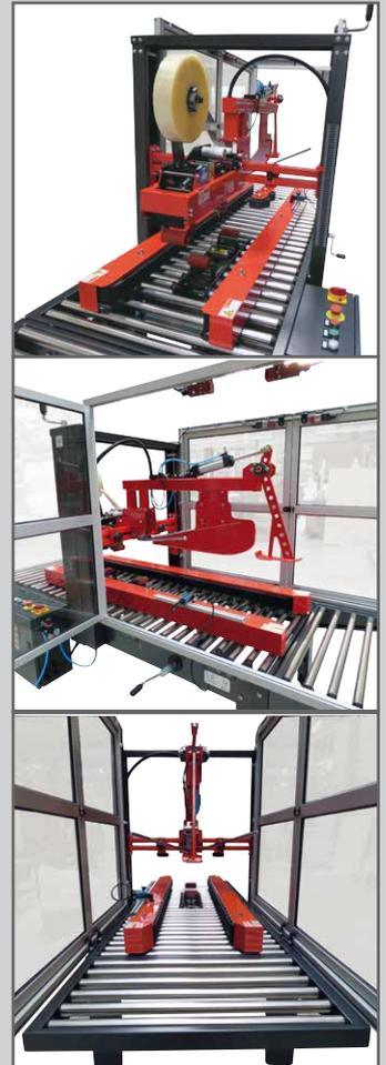
Unser Kartonverschließer SH-FJ-3A ist vielseitig einsetzbar. Serienkartons können in kurzen Intervallen zugeklappt und verschlossen werden. Diese Maschine ist besonders in Versandabteilungen beliebt, in denen lange Serien mit gleichen Kartonabmessungen verpackt werden, da die Kartongröße per Kurbel eingestellt wird.
