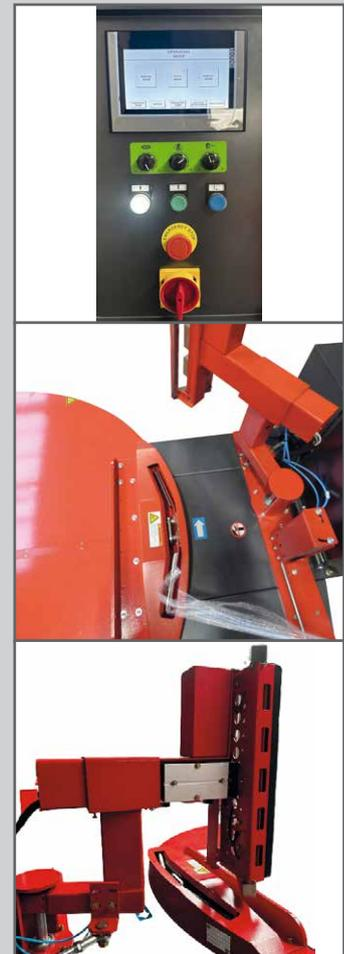
Der Palettenwickler SH-FG 2000 F ist eine vollautomatische Stretchmaschine der neuen Generation, inkl. Vorreckanlage und Fernbedienung. Automatische Bedienung, automatisches Anlegen der Folie, Wickeln, Abschneiden, Andrücken und Versiegeln. Sie können durch den Einsatz dieses Palettenwicklers eine erhebliche Entlastung Ihres Personals erreichen.
