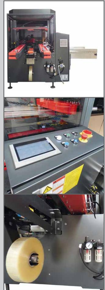
Der Robotic-Kartonaufrichter SH-CF-25TB ermöglicht eine besonders schnelle Aufrichtung Ihrer Kartons, gefolgt von einem sicheren Verschluss am unteren Ende, um sie nahtlos in den weiteren Verarbeitungsprozess einzuleiten. Die Eingabe der jeweiligen Kartongrößen erfolgt unkompliziert über das Bedienfeld, während hochpräzise Servomotoren die Maschine entsprechend einrichten. Für den Betrieb benötigen Sie lediglich eine 230V Stromversorgung und einen Druckluftanschluss.
