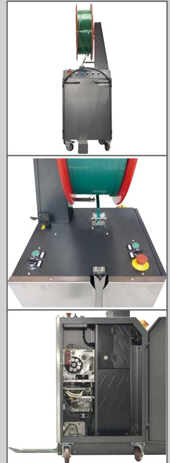
Der SH-ST-3150 ist ein kompakter Palettenumreifer mit elektrisch verfahrbarem Schwert zum Unterfahren von Paletten. Mit diesem kleinen Gerät ist man an verschiedenen Einsatzorten sehr flexibel. Die Umreifung geschieht mittels handelsüblichem PET-Umreifungsband. Die Bandspannung kann dabei stufenlos auf bis zu 150 daN Bandspannung eingestellt werden. Einsatzbereiche sind zum Beispiel das Lager oder die Versandabteilungen.
