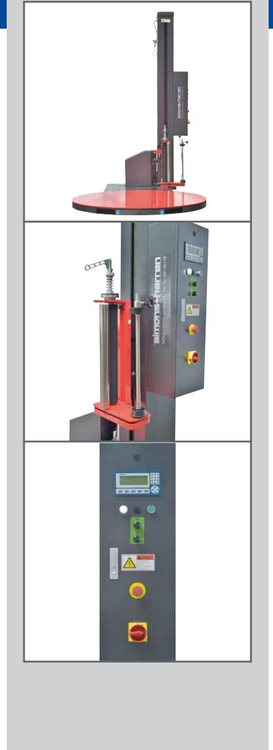
Der Palettenwickler SH-FG-1000 A ist unser Einsteigermodell für automatisches Einstretchen von Paletten. Die Maschine verarbeitet handelsübliche Maschinenstretchfolien in jeder gewünschten Qualität. Der Drehteller hat einen Durchmesser von 1500 mm und ist frequenzgesteuert. Der Folienschlitten ist für das automatische Abtasten der Palettenhöhe mit einer Fozelle ausgerüstet.
