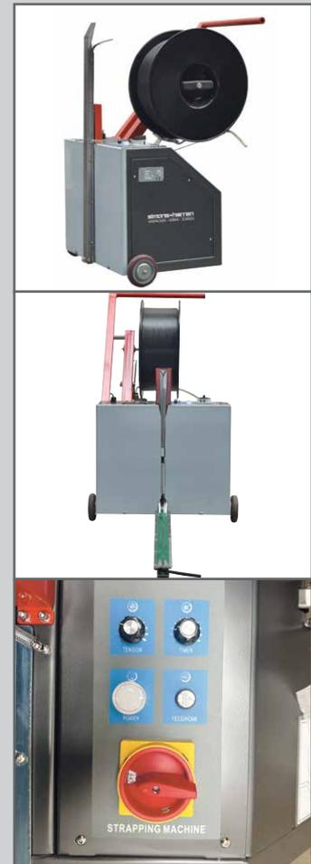
Der SH-ST-45 ist ein platzsparender Palettenumreifer mit einem klappbaren Schwert zum bequemen Unterfahren von Paletten. Dieses kompakte Gerät bietet maximale Flexibilität an verschiedenen Einsatzorten. Er wird mit herkömmlichem PP-Umreifungsband betrieben und ermöglicht eine stufenlose Einstellung der Bandspannung von bis zu 45 kg. Ideal für den Einsatz in Lagern, Versandabteilungen und ähnlichen Bereichen.
