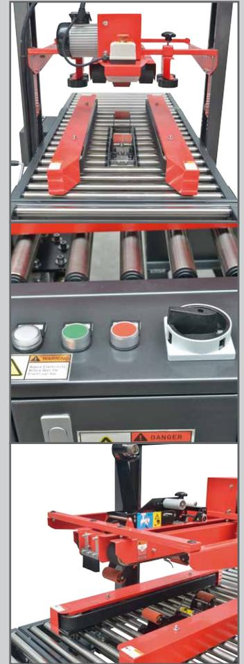
Der SH-FJ-1A ist die nächst größere Variante für Serienkartons. Auch hier wird die Größe der Kartons manuell per Kurbel eingestellt und anschließend automatisch versiegelt. Zum Einsatz kommt handelsübliches Klebeband.
