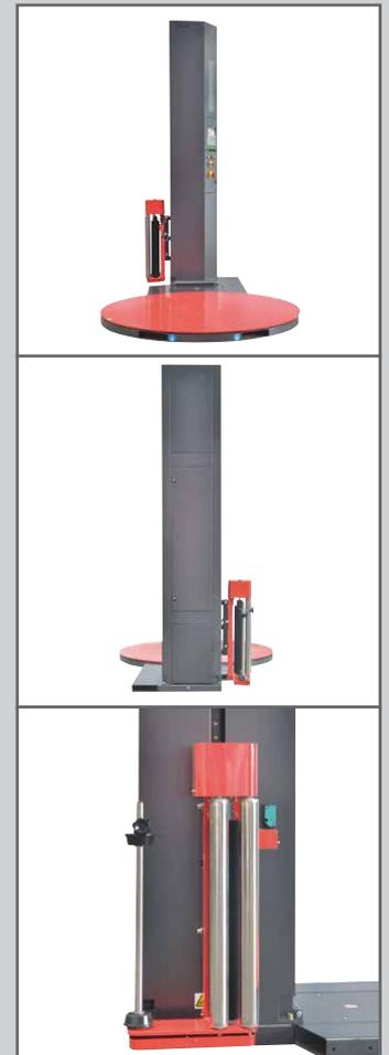
Der Palettenwickler SH-FG-2000 AE ist unser meistverkauftes Modell für automatisches Einstretchen von Paletten. Die Maschine verarbeitet handelsübliche Maschinenstretchfolie in jeder gewünschten Qualität. Der Drehteller hat einen Durchmesser von 1500 mm und ist frequenzgesteuert. Der Folienschlitten ist mit einer Fotozelle ausgerüstet für das automatische Abtasten der Palettenhöhe.
