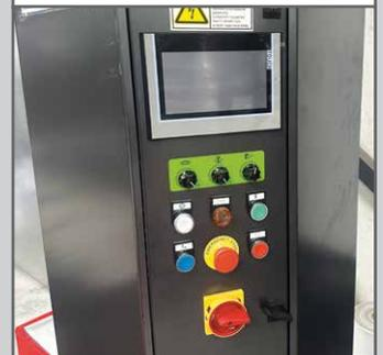
Unser SH-FG 2020 BL ist ein flacher Palettenwickler für automatisches Einstretchen von Paletten mit Vorreckanlage. Die Tellerhöhe beträgt nur 30 mm und ist darum extrem niedrig. Der Drehteller hat einen Durchmesser von 1650 mm und ist frequenzgesteuert. Das Beladen des Palettenwicklers mit normalen Hubwagen ist problemlos.
