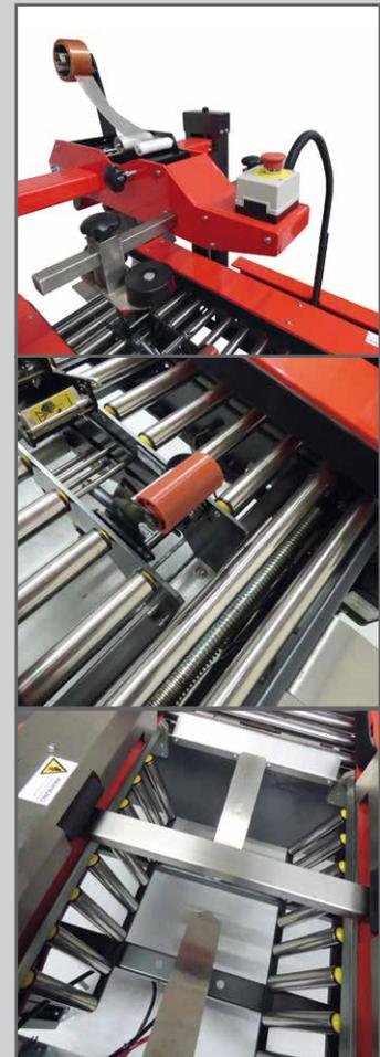
Der SH-601AW hat einen integrierten Bodenklappenfalter, für den Sie einen Druckluftanschluss benötigen. Die Einstellung der Kartongröße geschieht manuell per Kurbel für Serienkartons. Die Ein- und Ausfahrrollenbahn ist optional erhältlich! Einfach in der Bedienung und schnell im Handling.
