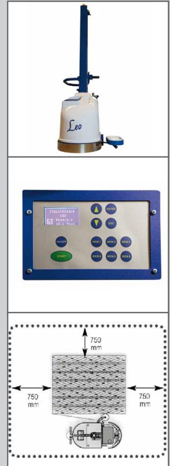
Der SH-LEO ist der kleinste Stretchroboter für automatisches Einstretchen von Paletten auf dem Markt. Die Maschine stretcht Paletten fast jeder Größe eigenständig ein und benötigt dazu einen Platz von nur 750 mm um das Packgut herum. Die Mindestgröße für Paletten beträgt 400 x 600 mm. Der Folienschlitten ist für das automatische Abtasten der Palettenhöhe mit einer Fotozelle ausgerüstet.
