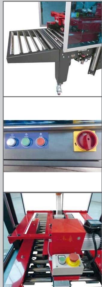
Der vollautomatische Kartonverschießer SH-FJ-2 ist besonders bei ständig wechselnden Kartongrößen geeignet. Schneller Verschluss von Boden und Deckel bei automatischer Höhen- und Seitenanpassung. Die Integration in vorhandene Verpackungsumgebungen ist leicht möglich.
