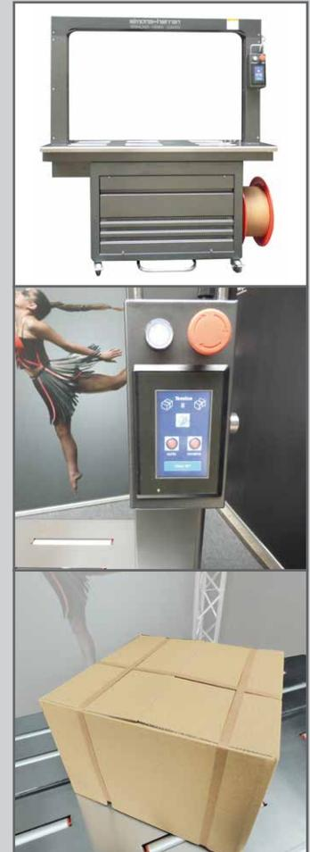
Die vollautomatische Umreifungsmaschine SH-512 ist vielseitig einsetzbar. Sie dient dem schnellen Bündeln von Waren oder dem einfachen Umreifen von Paketen und kann sowohl mit PP- als auch mit Papierumreifungsband genutzt werden. Betreiben Sie die Maschine im manuellen Modus oder vollautomatisch. Bedient wird sie ganz einfach per Knopfdruck oder Fußschalter und kann über den Touchscreen genaustens eingestellt werden. Die Produktionsleistung liegt bei ca. 65 Umreifungen pro Minute.
