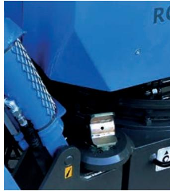
Sicherer Stand durch Exzenterverriegelung
