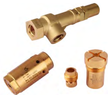
高压泄压阀 High pressure relief valve 制冷剂 Refrigerants : CFC, HCFC, HFC, R744 温度范围 Working temperature range : -40℃ ~ +140℃ 规格尺寸 Specification and size : DN6 ~ DN20 整定压力 : 0.3 ~ 18.0 MPa 优点 Features and advantages : 安全性高 High safety performance 稳定性好 good stability 安装方便 easy installation 使用寿命长 long service life CE certification
