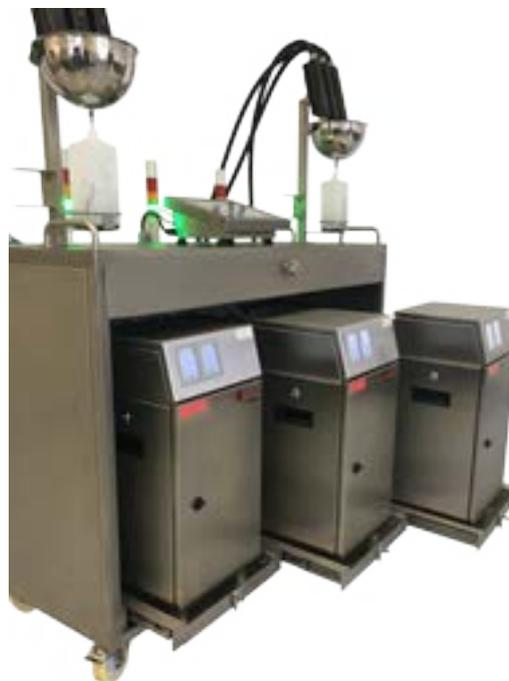
Mehrkopfanlage für bis zu 16 Druckköpfe
