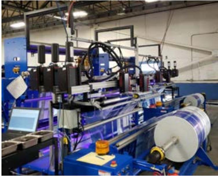
iM2 UV-Drucksystem für den Eindruck in Folienbahnen
