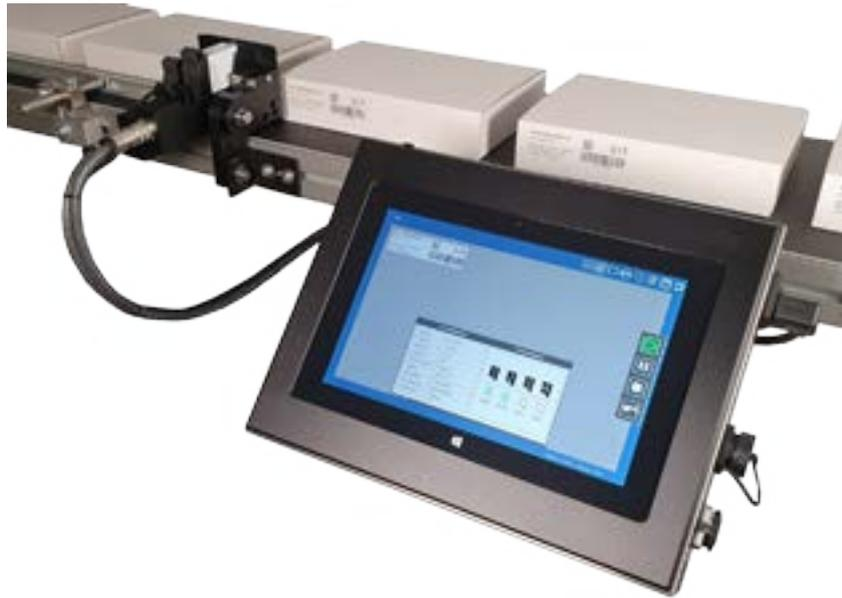
Druckbereich von 12,7mm bis 203 mm
