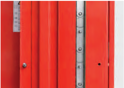
Die Kette aus verzinktem Kohlenstoffstahl wird automatisch gereinigt und geschmiert
