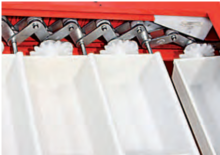
Abstandshalter rotierend auf Zahnstange
