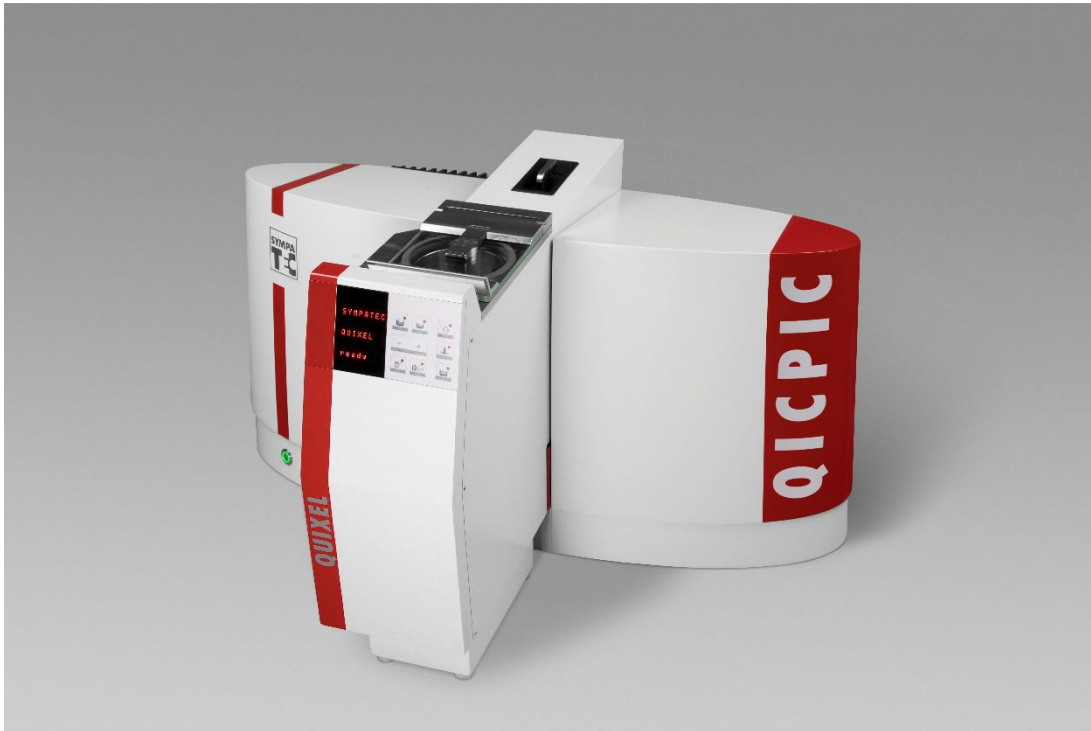
Figure 1: QICPIC/S in Kombination mit dem Nassdispergierer QUIXEL/S zur dynamischen Bildanalyse von Suspensionen und Emulsionen.
