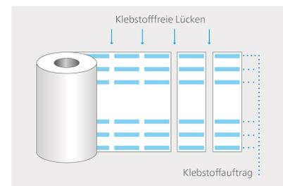
Aufbau CleanCut Linerless
