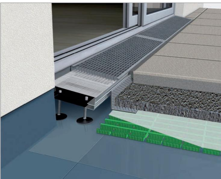
Genau für diesen Einsatzbereich hat Gutjahr das Komplettsystem aus AquaDrain FLEX Drainrosten und passenden Flächendrainagen entwickelt. Die bauseits ablängbaren Drainroste werden vor Balkon- und Terrassentüren oder vor bodentiefen Fenstern eingebaut. Damit sind regelgerechte barrierefreie Türanschlüsse einfach und sicher umzusetzen.
