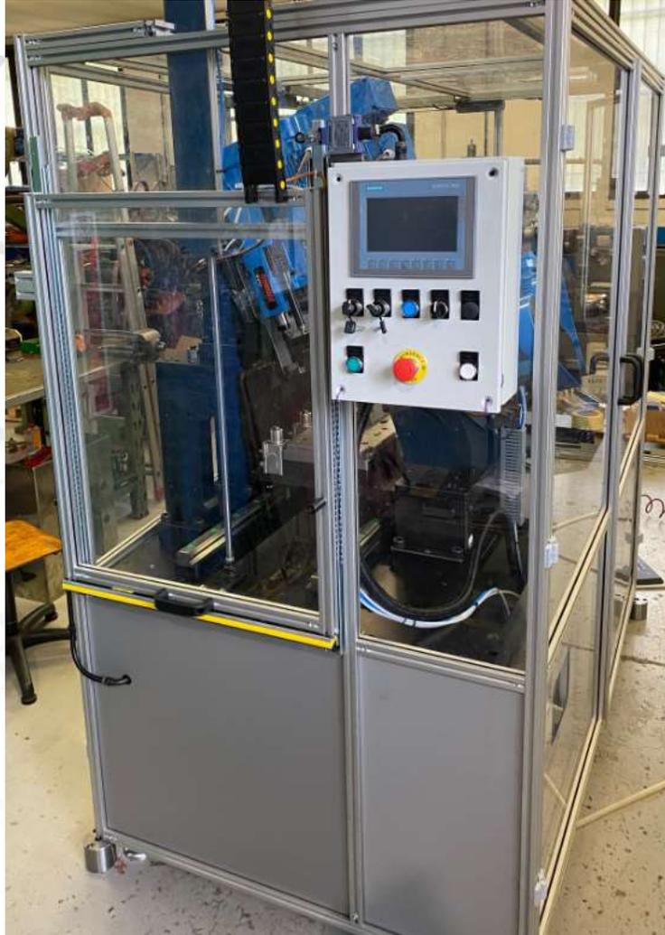
Bohr- und Gewindeschneidmaschine Aluminiumbauteil
