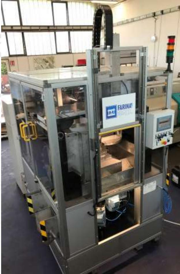
Bohren + Sägen + Stanzmaschine für Aluminiumteile
