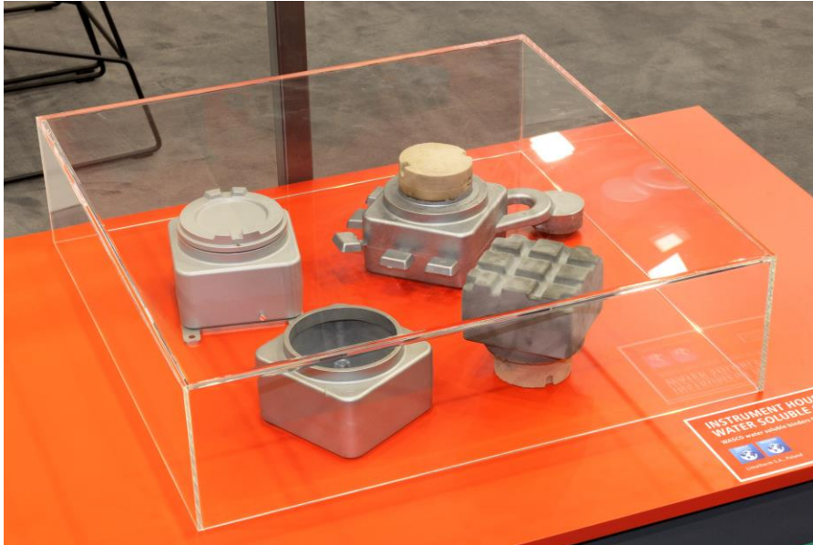
Foto : Die Wasserlöslichkeit von WASCO zeigt die klaren Vorteile gegenüber herkömmlichen Kernen.
