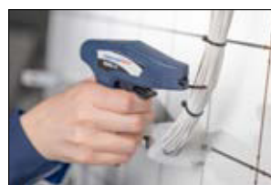
EVO cut: Entfernt sicher den Kabelbinder vom Bündelgut.
