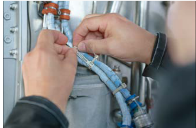
Kabelbinder mit Außenverzahnung und Kennzeichnungsschild HFTP48 aus PEEK.
