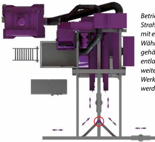
*Betrieb der Hängebahn-Strahlanlage („Y-Bahn“) mit einer Weiche. Während ein Werkstückgehänge be- oder entladen wird, kann ein weiteres Gehänge oder Werkstück gestrahlt werden.*
