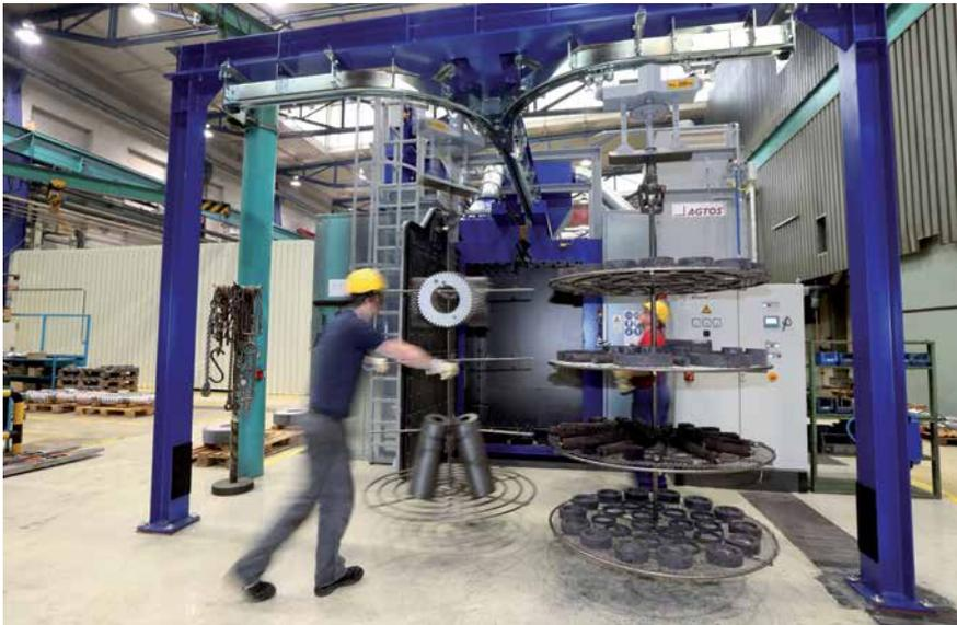
Hängebahn-Strahlanlage für Getriebeteile als Insellösung
