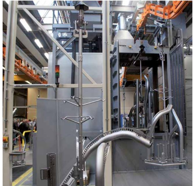
*Durchlaufhängebahn-Strahlanlage für Schweißkonstruktionen mit einseitig angeordneten Turbinen*
