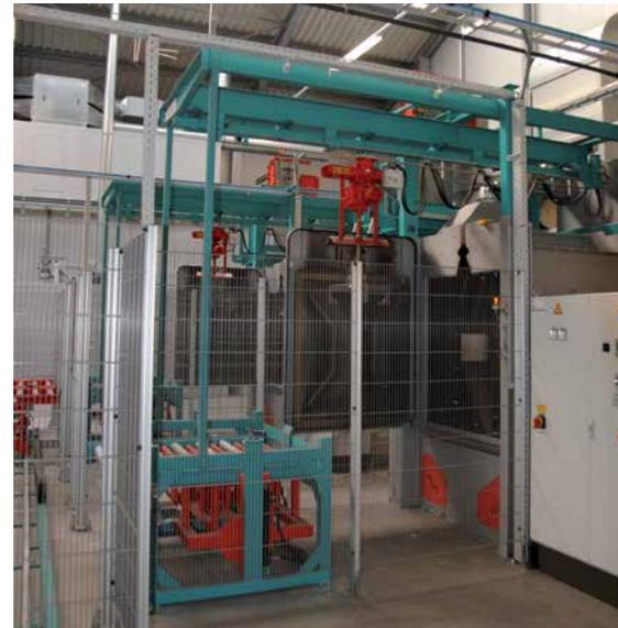
Hängebahn-Strahlanlage für Verbindungselemente in einer Bearbeitungslinie
