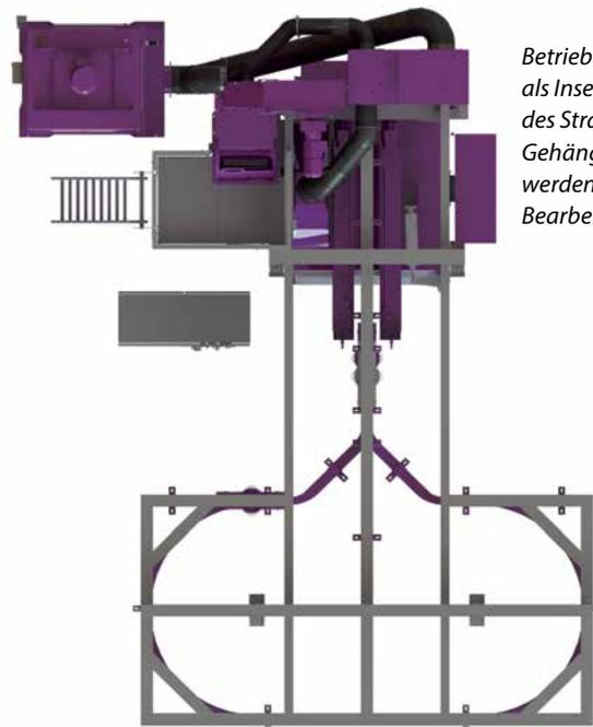
*Betrieb der Hängebahn-Strahlanlage als Insellösung mit Oval. Während des Strahlprozesses können weitere Gehänge zu- oder weggefördert werden. So ist eine kontinuierliche Bearbeitung möglich.*
