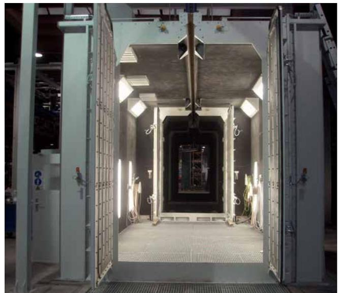
*Durchlaufhängebahn-Strahlanlage für Schweißkonstruktionen mit manuellem Nachstrahl- und Abblasraum*
