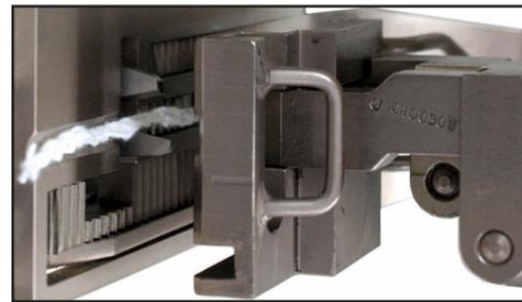
Elektropneumatisch betätigte Schere.
