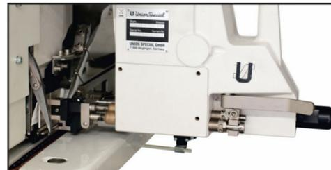
Elektropneumatisch betätigter Bandabschneider.
