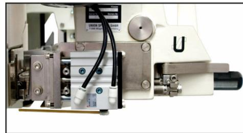
Elektropneumatisch betätigte Guillotine.
