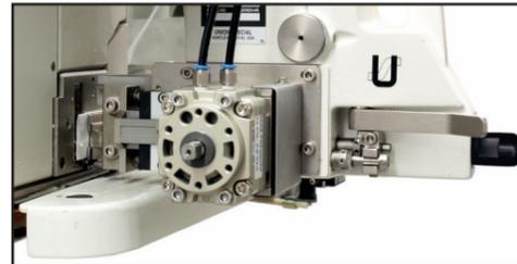
Elektropneumatisch betätigte schnelle Guillotine.
