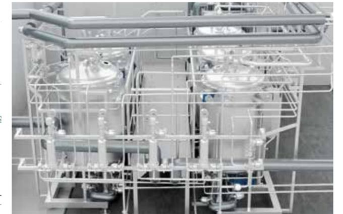
Konzeption, Konstruktion und Bau einer Pharma-anlage. Die Anlage besteht aus 15 Behältern und einer CIP-Anlage. Aufgebaut auf 7 Skids in 3 Räumen inklusive der Verrohrung der Anlage vor Ort. Besonderer Wert wurde auf die Reinigbarkeit der Anlage sowie der Produktrohrleitungen gelegt. Anlagenerstellung erfolgte unter Berücksichtigung der Druckgeräterichtlinie (DGRL), Maschinenrichtlinie (MRL) und ATEX-Richtlinie (ATEX). Inklusive Inbetriebnahme und Qualifizierung der Anlage.
