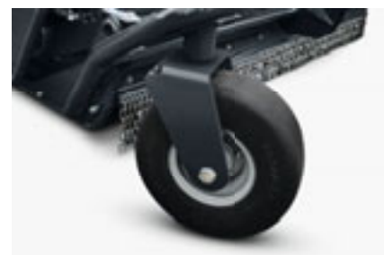
Die unplattbaren Reifen sorgen für mehr Einssatzsicherheit 2+3
