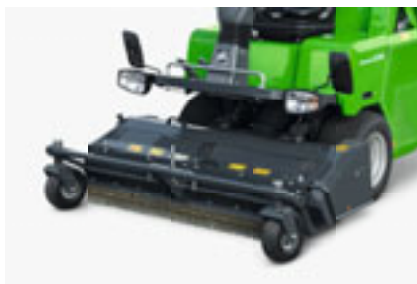
Beleuchtung für die Straßenfahrt
