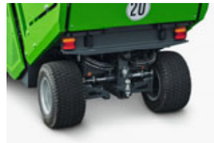
LED-Heckbeleuchtung des Beleuchtungssets
