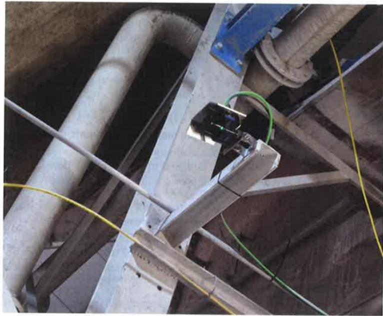
2 OWL EYE LiDAR Sensor über einem Förderband erfasst kontinuierlich das Querschnittsprofil des Förderguts
