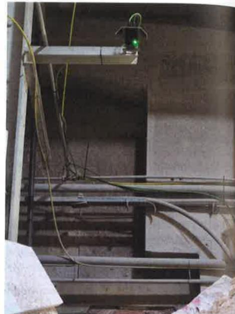
3 OWL EYE LiDAR Sensor ermöglicht eine detaillierte Zustandsüberwachung des Förderbandes
