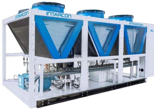
Ammoniak-Kühlanlagen mit direkter Expansion und der von INTARCON entwickelten Technologie der geringen Füllmenge für industrielle Niedertemperatur-Anwendungen. Kompakte Konstruktion mit Luftkondensation, mit Aufbau und Rahmen aus verzinktem Stahl und Polyester-Lack für die Installation im Außenbereich.
