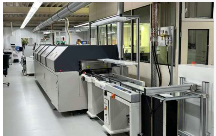
Reflow-Ofen mit Schutzgasatmosphäre
