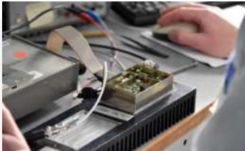
Programmierung eines Funkmoduls
