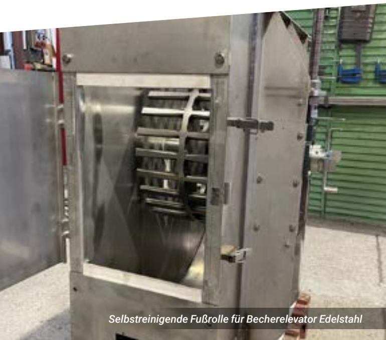
Selbstreinigende Fußrolle für Becherelevator Edelstahl
