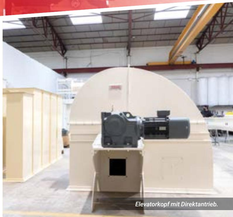
Elevatorkopf mit Direktantrieb.
