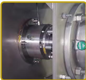
Standardelastomer für den O-Ring ist FDA Viton®. Für Wellen mit großem Durchmesser oder stark aggressive Prozessmaterialien wird ein austauschbarer, gehärteter Statoreinsatz (der geschliffene Mittelring im Fotos) angeboten. MECO-Dichtungen können aus einer breiten Palette geeigneter Materialien hergestellt werden.
