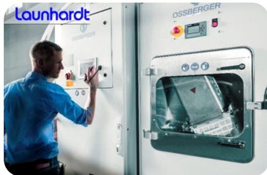
„Das Entpacken von SLS-Bauteilen wird zumeist händisch umgesetzt und birgt die Gefahr der Kontamination des Pulvers durch Fremdstoffe, was eine erhöhte Prozessinstabilität beim additiven Fertigungsprozess nach sich zieht, sowie die Gefahr der Kontamination der Mitarbeiter durch aufwirbelndes Pulver.“
