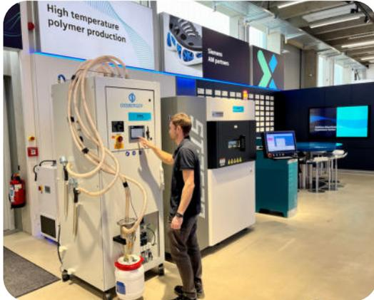
"Die gleichermaßen einfachen und funktionalen Einzelmodule von OSSBERGER wie der FS SPINNER (Entpacken von SLS-Baujobs) und der FS POWDER (Aufbereiten und Mischen von SLS-Pulver) reduzieren den manuellen Aufwand erheblich. OSSBERGER ist für Siemens Digital Industries aber nicht nur Lieferant und Partner bei der Additiven Fertigung, sondern nutzt für die steuerungstechnische Ausrüstung der Anlagen auch Siemens Komponenten."
