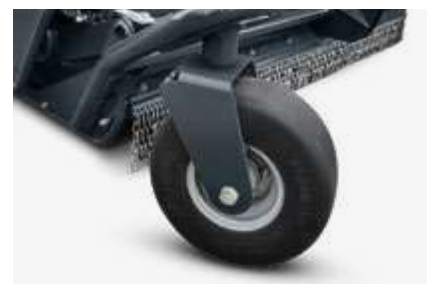
Die unplattbaren Reifen sorgen für mehr Einsatzsicherheit 2+3
