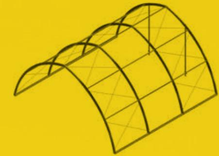
Die Konstruktion der Profilträgerbogenhallen besteht aus eingerollten Doppel-T-Trägern, welche mit technischen Textilien eingedeckt und verkleidet werden.
