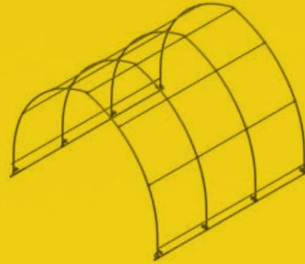
Die Konstruktion der Rundrohrbogenhallen besteht aus eingerollten Rundrohren mit technisch-textiler Verkleidung.
