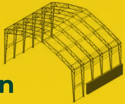
Die Konstruktion der Gitterträgerhallen besteht aus Stahlhohlprofilen, welche je nach statischen Anforderungen als unterschiedlich dimensionierte Fachwerkträger mit textiler Eindeckung und Verkleidung ausgeführt werden.
