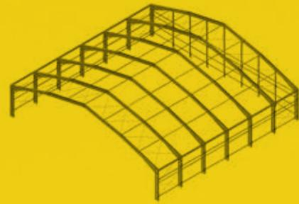
Die Konstruktion der Profilträgerhallen wird mit schlanken Stahlprofilen (Doppel-T-Trägern) den statischen Anforderungen entsprechend ausgeführt.
