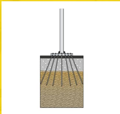
Bolzenanker auf Betonfundamenten
