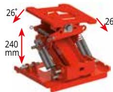
Höhenausgleich H 240 P / Parallelogramm 240 mm, Pendel links/rechts 26° (max. Gewicht Mulchkopf 300 kg)
