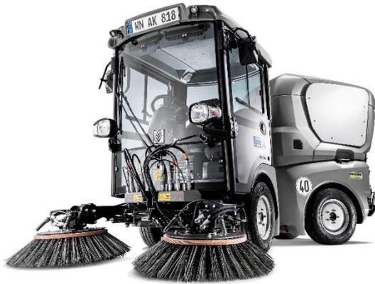
*Die MC 150 ist eine neue, multifunktionale Kehrmaschine von Kärcher, die sich wie ein Geräteträger mit verschiedenen Anbaugeräten ausstatten lässt.*
