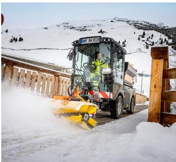
*...oder mit einer Frontkehrmaschine eingesetzt werden.*
