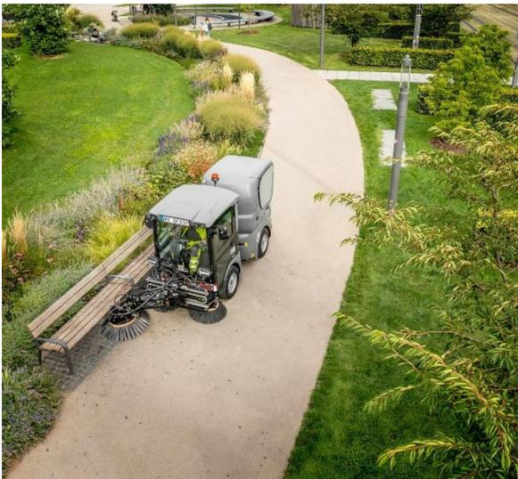
*Das strömungsoptimierte Saugsystem liefert sehr gute Ergebnisse selbst bei niedriger Motordrehzahl und ist besonders kraftstoffsparend. Die Reinigungsleistung ist mit der nächsthöheren 2 m<sup>3</sup>-Modellklasse vergleichbar.*
