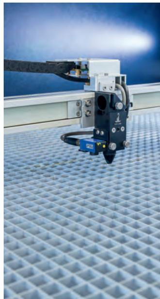
Gitterschneidisch mit Vakuumfunktion
