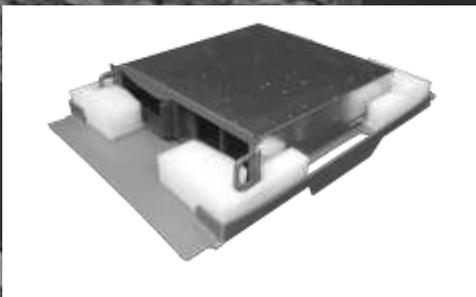
Verpackungen aus Schaum bieten ein breites Anwendungsspektrum. Neben der Schaumstoffart lässt sich mit einer gezielten Auswahl der Dichte die Polstereigenschaft anpassen. Die konturgenaue Formgebung ermöglicht einen optimalen Schutz hochempfindlicher Geräte. Besonders für kleine und mittlere Stückzahlen sind die geringen Werkzeugkosten ideal.
