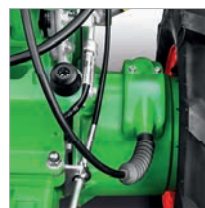
Robuste Lenkbremskupplungen für einfaches Lenken
