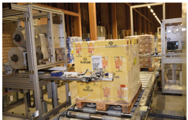
Stirnseitenetikettierung in verschiedenen Höhen
