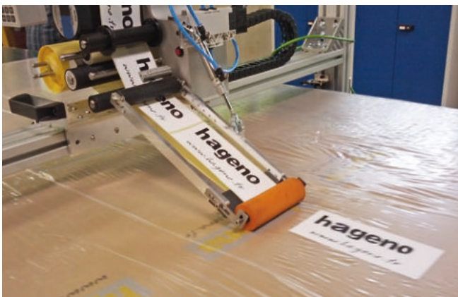
Spendesystem für Mehrfachetikettierung
