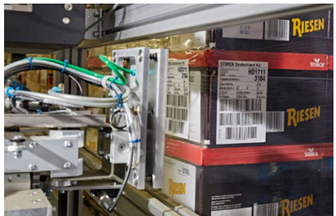
2-Seiten Etikettierung auf Längs- und Rückseite
