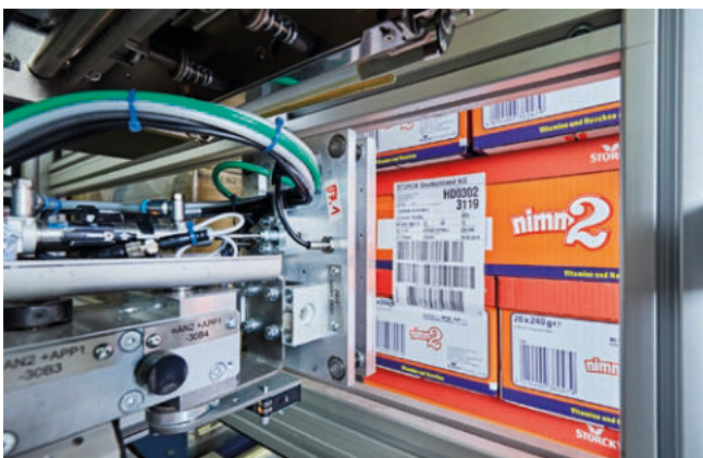
Palettenetikettierung mit Codeverifizierung
