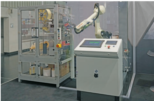
Roboterzelle mit 1:1 Vollfarbdruck und Spendemodul
