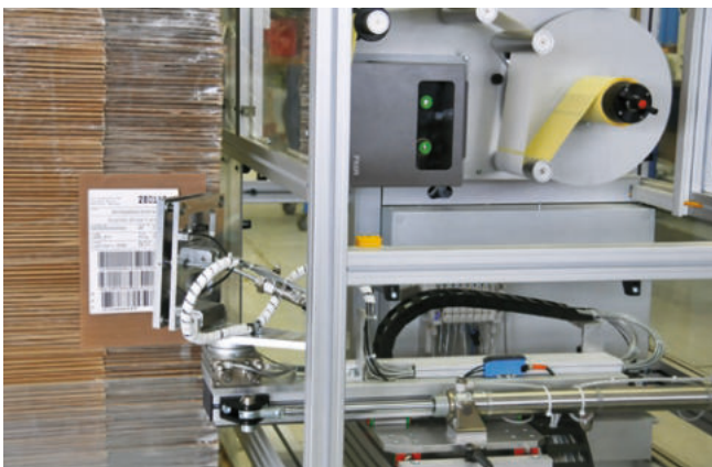
Applizieren von Etiketten auf Wellpappestapel
