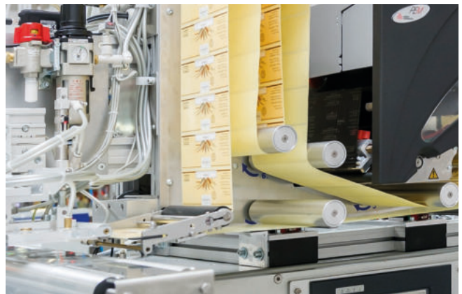
Drucken und Spenden auf Folienverpackungen
