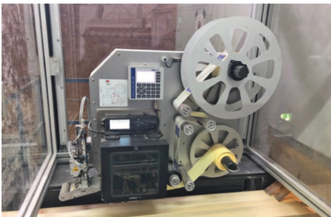
Durchlaufetikettierung von Leimbindern
