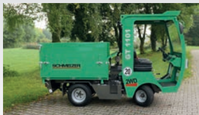
Dreiseitenkipper in Stahl und Aluminium ausgeführt
