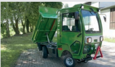
Dreiseitenkipper in Stahl und Aluminium ausgeführt
