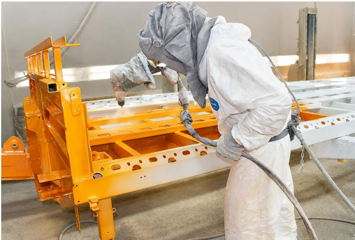
Duplex-Beschichtung: Feuerverzinkung + Lackierung = maximale Lebensdauer
