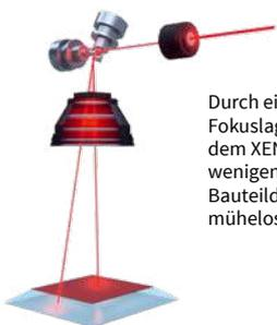
Durch eine verstellbare Fokusslage lassen sich mit dem XENO 4S innerhalb wenigen Millisekunden Bauteildifferenzen mühelos ausgleichen.
