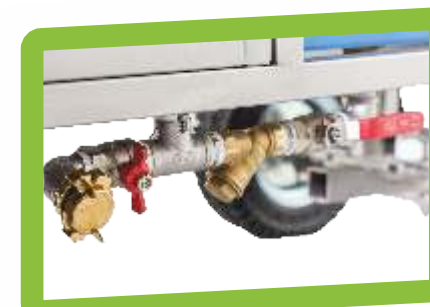
- Anschluss zum Ansaugen aus einem externen Behälter - Schmutzfilter in der Ansaugung
