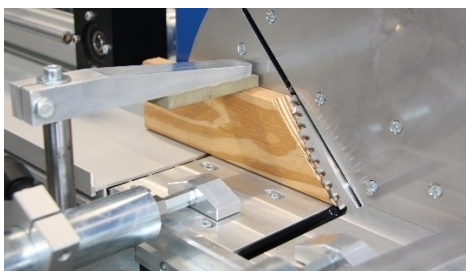
Kombiniertes Spannelement: einzeln zu- und abschaltbar (Tasten)
