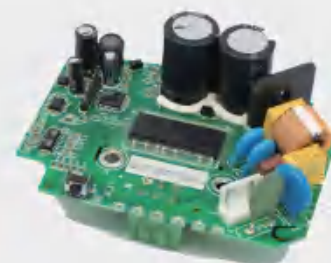
家用循环泵驱动控制器 - 120W Circulating Pump Driver-120W
