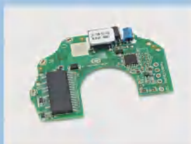
空调风机直流驱动器 - 150W Air Conditioner DC Fan Driver - 150W
