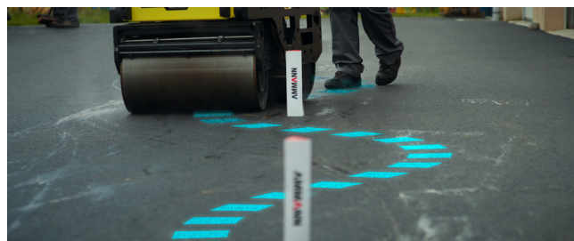
ARW 65-S Handgeführte Walze mit 15° Lenkwinkel
