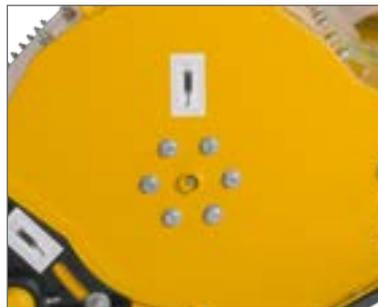
Innenliegendes Rotorlager zum Schutz vor Fremdkörpern und Kollisionen. Ein „Wickeln“ von langfaserigem Material wird durch den gesonderten Wickschutz vermieden.
