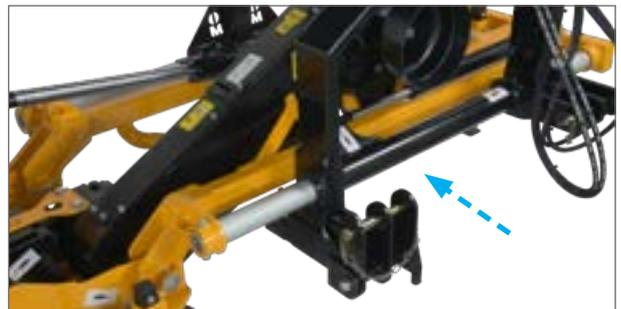
Die mechanische Anfahrssicherung schützt das Mulchgerät im Ernstfall effektiv vor Kollisionsschäden.
