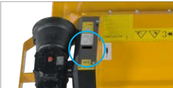
Keilriemenspannung immer im Blick: Keilriemenschutz mit Kontrollöffnung.
