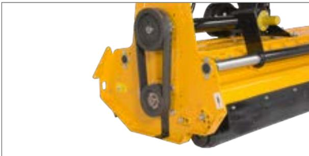
Zapfwellendrehzahlen von 540 oder 1.000 U/min sind möglich.
