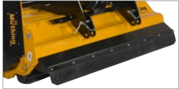
Der Staubschutz für Trägerfahrzeuge beugt einer Beeinträchtigung des Sichtfeldes und einer übermäßigen Verschmutzung tiefliegender Ansaugpunkte durch Staubeentwicklung vor.
