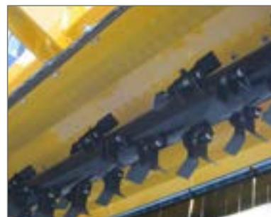
Durch die am Rotor montierten speziellen Y-Messer bei einer variabel verstellbaren Arbeitshöhe bis ca. 11 cm entsteht eine geringere Sogwirkung, wodurch Reptilien und Kleinlebewesen am Boden verbleiben und nicht mit den Y-Messern in Kontakt kommen.
