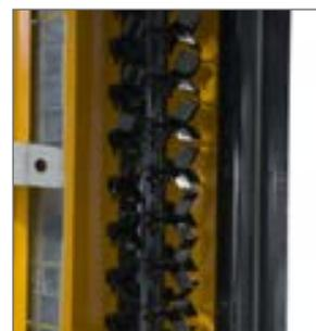
Robuste, schraubbare M-Hartmetall Schäkelmesser und die durchgängige, nachlaufende Stützwalze perfektionieren das Mähergebnis. Laufruhige 2-fach Y-Messer sind optional verfügbar.
