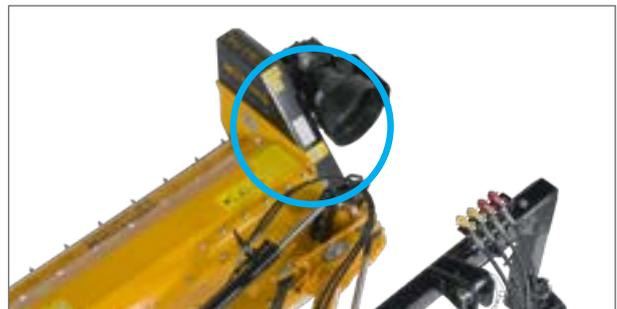
Keilriemenspannung immer im Blick: Keilriemenschutz mit Kontrollöffnung.
