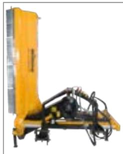
Dank durchdachter Bauweise lässt sich das MU-E/S Mulchgerät platzsparend zusammengeklappt abstellen.
