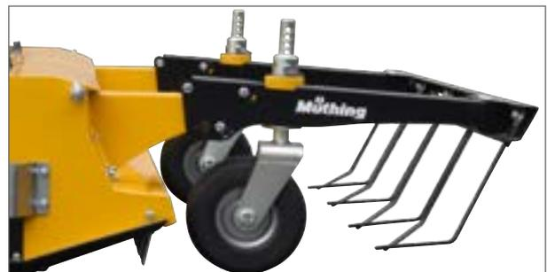
Serienmäßige Frontstützräder erleichtern die Handhabung und verbessern die Bodenanpassung. Sie sind höhenverstellbar und 360° schwenkbar. Optional ist ein vorgebauter Insektenretter verfügbar.
