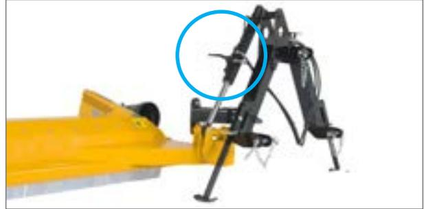
Gut zu erreichende Transportsicherung mittels Absperrhahn.
