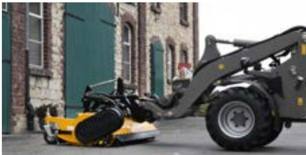
Fahrzeugspezifische Anbauteile: Der niedrige Koppelpunkt sorgt für eine gute Übersicht durch die tiefe Schwingenposition. Gute Zugänglichkeit für die hydraulischen Verbindungen.
