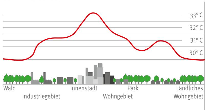
Die Wärmeinsel ist insbesondere das Resultat dichter Bebauung und Flächenversiegelung. Verstärkt wird der Effekt durch dunkle Befestigungen von Dächern und Verkehrsflächen, die Sonnenwärme speichern und so die Umgebungsluft aufheizen. Selbst die Nacht bringt kaum Abkühlung.
