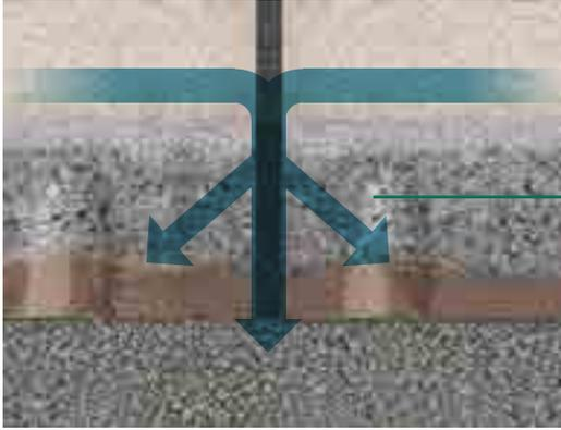
In dem Pflastersystem versickert das Regenwasser über Fugen. Die für eine Fugenversickerung erforderliche Fugenbreite beträgt je nach Steindicke zwischen 5 und 9 mm, dabei liegt der flächenbezogene Fugenanteil zwischen 5 und 10 %.
