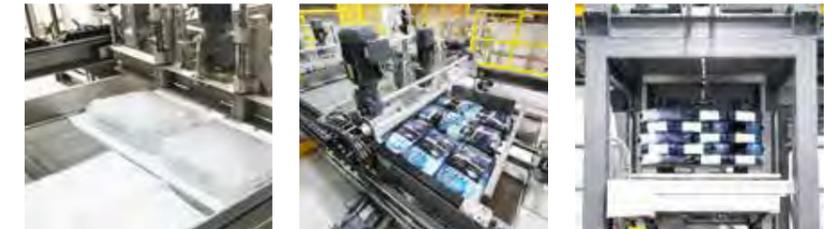
Der Hochleistungs-Robotpalettierer PRINCIPAL-R, ein Knickarm-Robotpalettier-System, wird stets als kundenspezifische Lösung mit namhaften Industrieroboter-Herstellern und dem STATEC BINDER Know How angeboten. Je nach gewünschter Leistung kommen unterschiedliche Robotermodelle zum Einsatz. Dabei wird auch der Greifer auf den jeweiligen Anwendungsfall abgestimmt. Eine Besonderheit des PRINCIPAL-R ist, dass er für sogenannte Sling Bags optimiert wurde.
