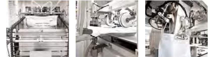
Der CERTOPAC, eine vollautomatische Hochleistungs-Verpackungsmaschine, verpackt jede Art freifließender Schüttgüter in Polster- und Seitenfaltensäcke mit einem Füllgewicht zwischen 5 kg und 80 kg. Dank hoher Geschwindigkeit können bis zu 1500 Säcke in der Stunde befüllt werden.
