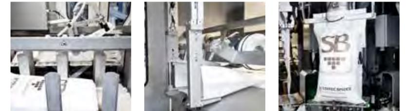
Der ACROPAC ist eine vollautomatische Verpackungsmaschine mit einer Produktionskapazität von bis zu 600 Säcken pro Stunde. Aus diesem Grund ist diese Maschine ideal für all jene, die von manueller/semi-automatischer Verpackung auf vollautomatische Verpackung umsteigen möchten und/oder eine geringe Kapazität benötigen. Egal ob, Kunststoffgranulat, Tierfutter, Düngemittel oder Lebensmittel – der ACROPAC ist ideal für das Verpacken von frei fließenden Schüttgütern.
