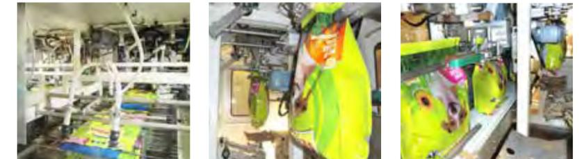
Die FFS-Combi Variante der Offensack-Verpackungsmaschinen hat, wie der Name vermuten lässt, ein zusätzliches FFS-Modul und erlaubt somit Säcke nicht nur aus dem Sackmagazin zu verwenden, sondern auch Säcke vom Folienschlauch herzustellen. Bei den Offensack-Verpackungsmaschinen sind der CERTOPAC und der PRINCIPAC als FFS-Combi Variante erhältlich. Auch beim Verpackungskarussell CIRCUPAC ist das zusätzliche FFS-Modul möglich.
