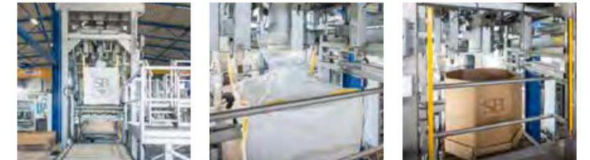
Die semi-automatische Big Bag Füllstation ermöglicht das Befüllen von Big Bags (FIBC) mit einer, zwei oder vier Schlaufen und Octabins mit einem Füllgewicht von 500 kg bis 1500 kg.
