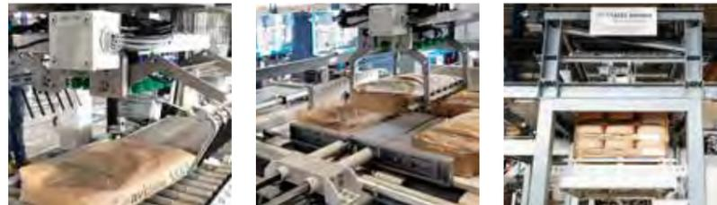
Der PRINCIPAL-P, ein Hochleistungs-Portalpalettierer, kombiniert die hohe Geschwindigkeit des PRINCIPAL mit einem Greifer, der auf den jeweiligen Anwendungsfall abgestimmt ist, wie z.B. kombinierte Greifer für das Palettieren von Säcken und Kartons.
