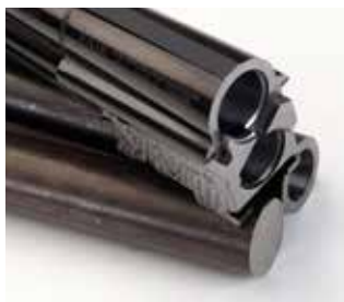
Canne in acciaio speciale trilegato, ricavate da foratura barra. Anima e camere cromate internamente, per assicurare maggiore durata e resistenza alla corrosione e rosate meglio distribuite. Special three-alloyed steel barrel machined out of bored bars. Internally-chromed bore and chambers for improved lifespan and corrosion resistance and better-distributed shot patterns. Canons en acier spécial à triple alliage, usinés à partir du percement de la barre. Ame et chambres chromées intérieurement pour garantir une meilleure durée et résistance à la corrosion et une meilleure régularité de gerbe.
