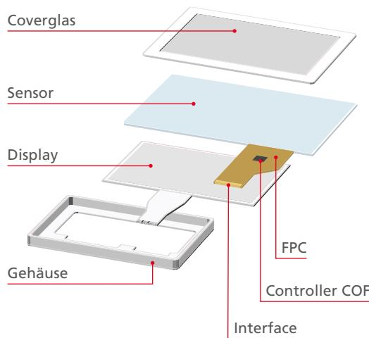
Kapazitive Bedienelemente – ob als Einzeltaste, Tastaturlfeld oder komplexe Touchfläche – bieten eine glatte, geschlossene Oberfläche ohne mechanisch bewegliche Teile. Sie sind somit resistent gegenüber Schmutz, Wasser und Chemikalien.
