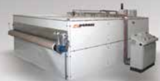
Bandtrockner für Textilien. Leistung: 70, 120, 250 kW
