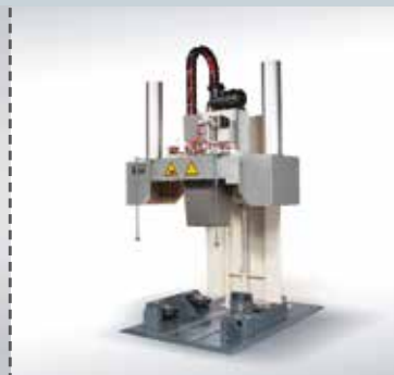
Beheizungsanlage zur Trocknung und Vorwärmung von Pfannen. Leistung: 100 kW
