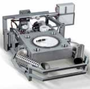
Beheizungsanlage zur Vorwärmung von Schmiedegesenken. Leistung: 500 kW
